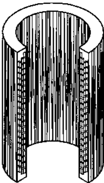
图 9.2-4 圆筒式绕组
